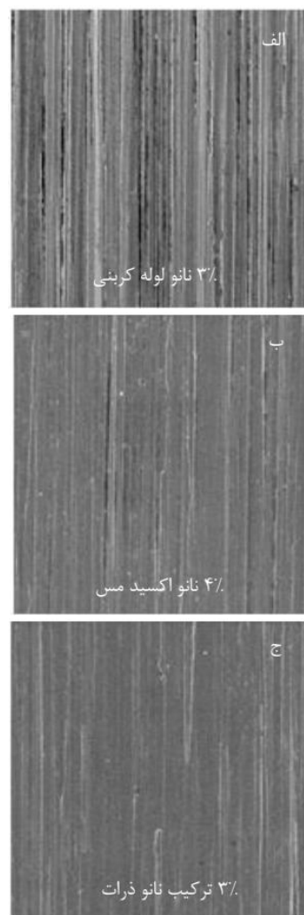
شکل ۹) مقایسه سلامت سطوح نمونه‌ها به ازای افزودن مقادیر مختلف از نانو ذرات در روغن پایه کلزا
