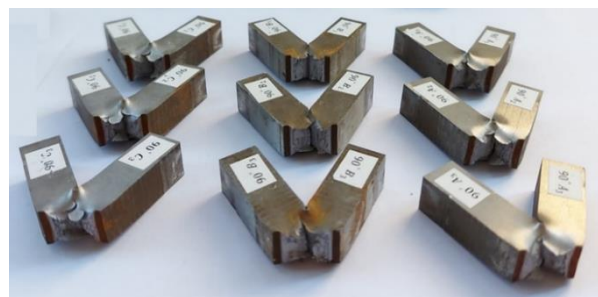
شکل ۵) تصویر تعدادی از نمونه های آزمایش شده پس از شکست.
