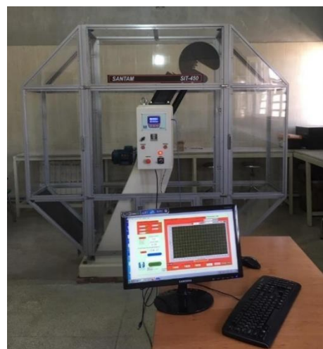
شکل ۴) نمای کلی دستگاه ضربه شاری در آزمایشگاه ضربه دانشگاه پیام نور کرمان.
