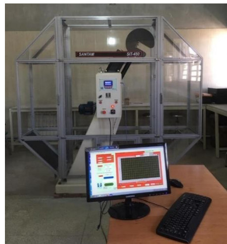
شکل ۴) نمای کلی دستگاه ضربه شاری در آزمایشگاه ضربه دانشگاه پیام نور کرمان.
