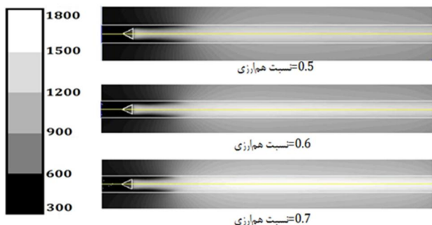
شکل 9 کانتور توزیع دما (کلونین) برای احتراق هیدروژن-هوا با سرعت ثابت ورودی 10 m/s و به ازای نسبت هم‌ارزی‌های مختلف
