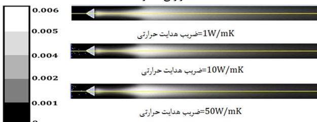
شکل 24 کانتور کسر جرمی رادیکال OH برای احتراق هیدروژن-هوا با سرعت ثابت ورودی 10 m/s و نسبت هم‌ارزی ثابت 0/5 و به ازای ضریب هدایت حرارتی‌های مختلف
