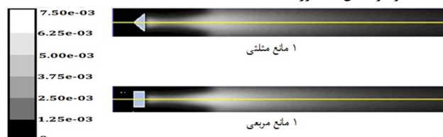
شکل 14 کانتور توزیع کسر جرمی OH برای احتراق هیدروژن-هوا با
