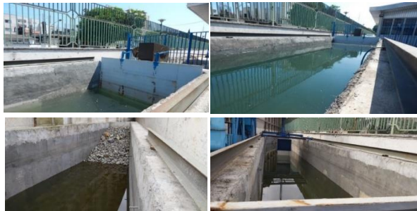
شکل ۴) نمای استخر موج، موج‌ساز و دمپر موجود در گروه پژوهشی انرژی‌های دریای پایه
