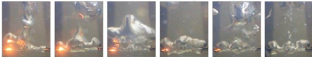
ب) رشد حباب در سیم حلقوی ۳ حلقه، شار حرارتی ۲۰۳۸ کیلووات بر مترمربع
