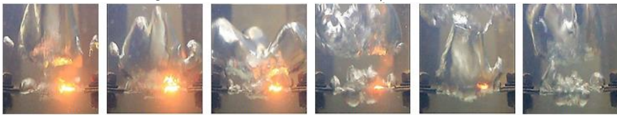
ذ) رشد حباب در سیم حلقوی ۱۰ حلقه، شار حرارتی ۲۰۳۶ کیلووات بر مترمربع
