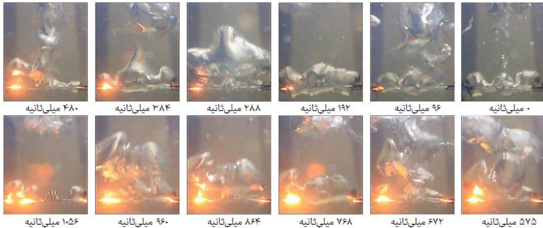
پ) رشد حباب در سیم حلقوی ۳ حلقه، شار حرارتی ۳۶۴۹ کیلووات بر مترمربع
