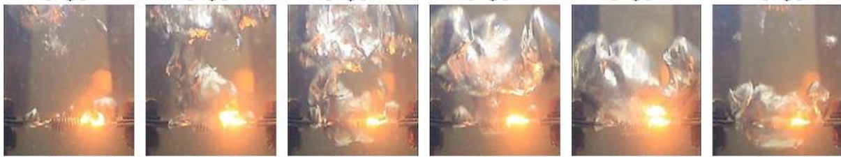
ر) رشد حباب در سیم حلقوی ۱۰ حلقه، شار حرارتی بحرانی ۲۴۷۹ کیلووات بر مترمربع
