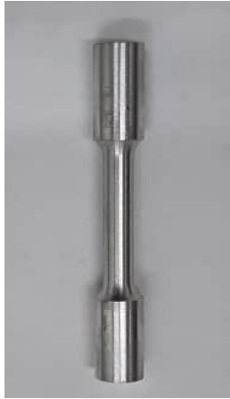
شکل ۱) نمونه آزمون کشش برای ارزیابی خواص مکانیکی
