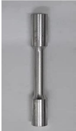
شکل ۱) نمونه آزمون کشش برای ارزیابی خواص مکانیکی
