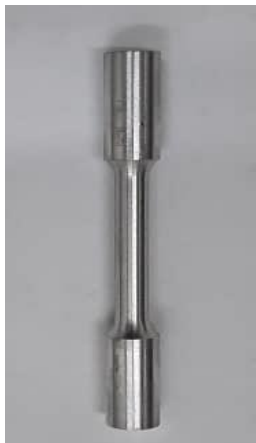
شکل ۱) نمونه آزمون کشش برای ارزیابی خواص مکانیکی
