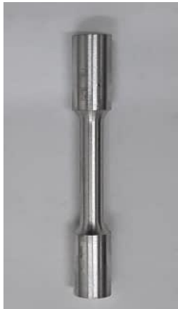
شکل ۱) نمونه آزمون کشش برای ارزیابی خواص مکانیکی
