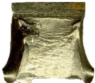
شکل ۴) تصویر سطح دو قسمت شکسته شده در دمای ۲۰+ درجه سلسیوس
