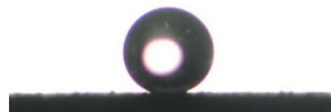
الف) نمونه 2 با زاویه تماسی حدود 161 درجه
