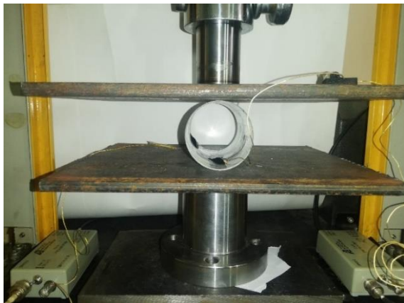
شکل ۱) بارگذاری لوله استوانه‌ای تحت بارگذاری جانبی شبه استاتیکی و سنسورهای متصل به نمونه
