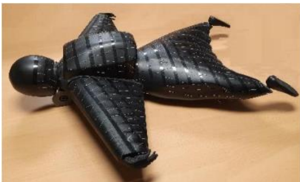
شکل ۵) نمونه آزمایشگاهی مدل وینگ سوت مورد مطالعه به همراه تافت
