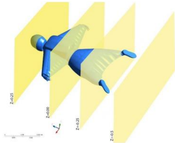
شکل ۱۳) جانمایی موقعیت فواصل طولی در راستای محور Z روی مدل
