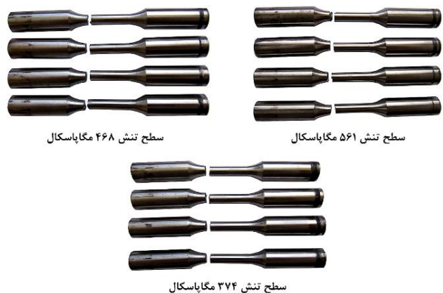
شکل ۳) نمایی از نمونه‌های آزمایش شده در سطوح مختلف تنش فلز جوش (شکل ۴) نمودار احتمال شکست مرتبه‌ای بر حسب عمر خستگی فلز جوش لوله فولادی API X65 در ناحیه عمر محدود خستگی
