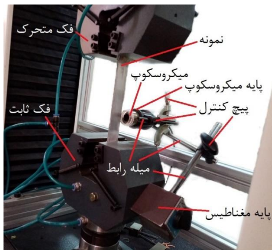
شکل ۳) چیدمان آزمایش میکروسکوپی
