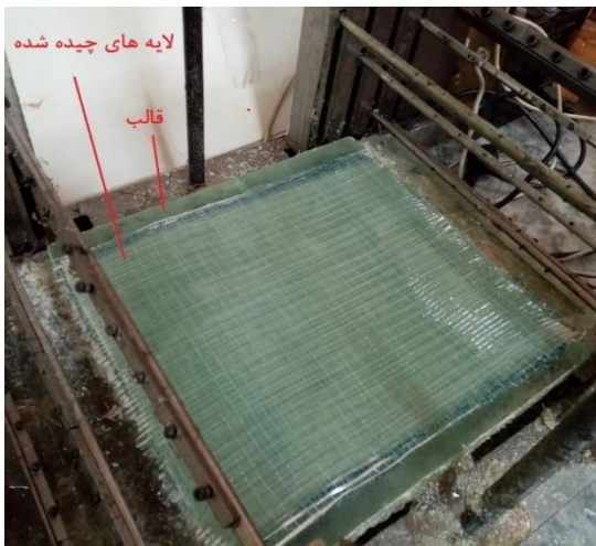
الف) لایه‌چینی دستی لایه‌های شیشه/اپوکسی روی سطح قالب
