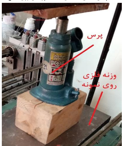
ب) تحت فشار قرار دادن نمونه به مدت حداقل ۲۴ ساعت
