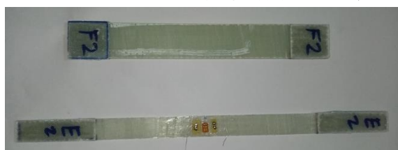
ج) آماده‌سازی نمونه‌ها با اتصال تب‌ها و کرنش‌سنج‌ها بر حسب نیاز (شکل ۱) فرآیند ساخت و آماده‌سازی نمونه‌ها
