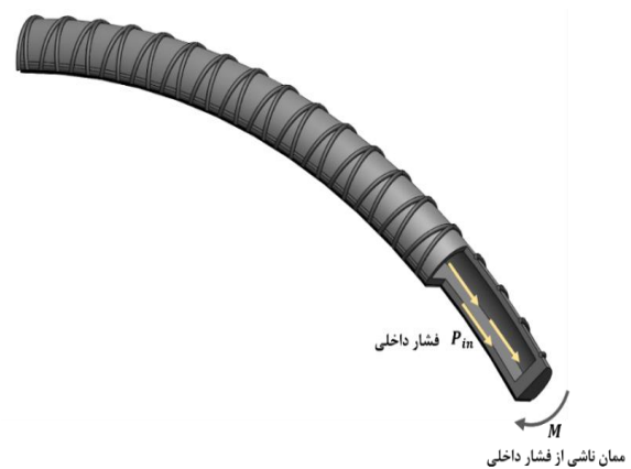
شکل ۳ نمایش فشار ورودی و اثر گشتاور ناشی از آن به عملگر خمشی
