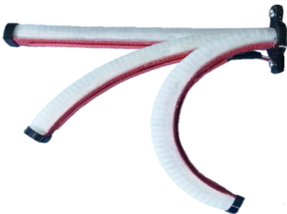
شکل ۱) عملگر نرم خمشی تقویت‌شده با فیبر در فشارهای مختلف
