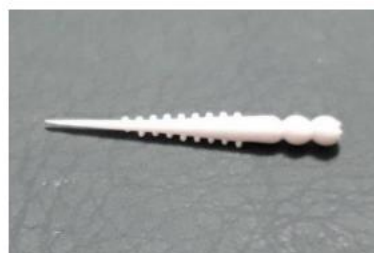
شکل ۹) نمایی از پین‌جت تولیدشده از جنس HIPS 7240
