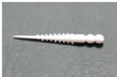
شکل ۹) نمایی از پین‌جت تولیدشده از جنس HIPS 7240
