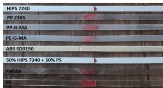
شکل ۲) نمونه‌های تهیه‌شده برای آزمون برشی لبروی هم
