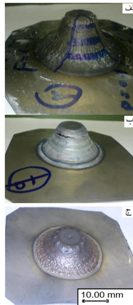
شکل 19 قطعات تولیدشده با حداکثر زاویه‌ی شکل‌دهی از ورق Ti-6Al-4V با
