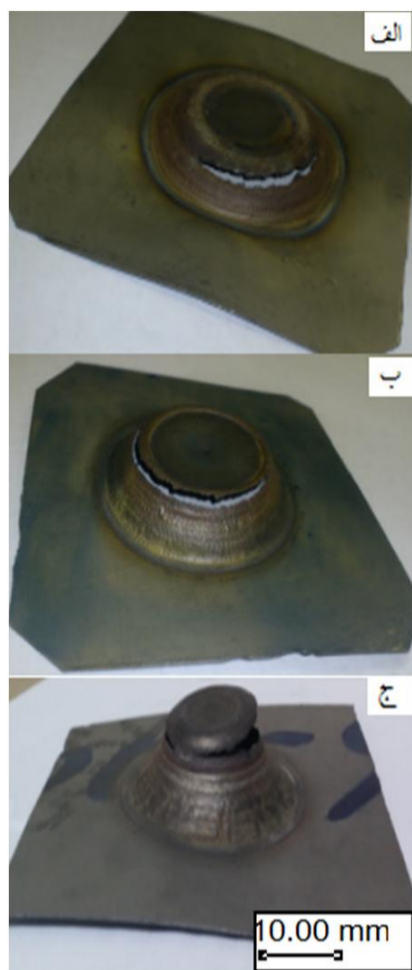
شکل 12 قطعات تولیدی از ورق Ti-6Al-4V در جریان‌های الف) 250-300 آمپر (ب) 200-250 آمپر ج) 150-200 آمپر
