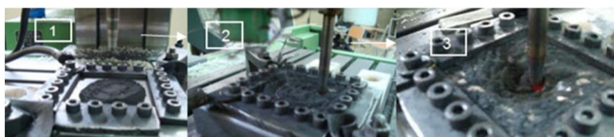
شکل 7 نحوه‌ی روانکاری سطح قطعه کار هنگام شکل‌دهی
