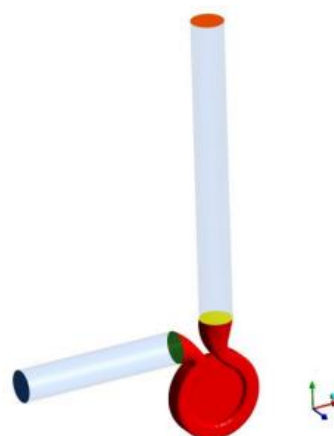
(الف) مرز آبی ورودی، مرز نارنجی خروجی، مرزهای سبز و زرد اتصال معمولی هستند
