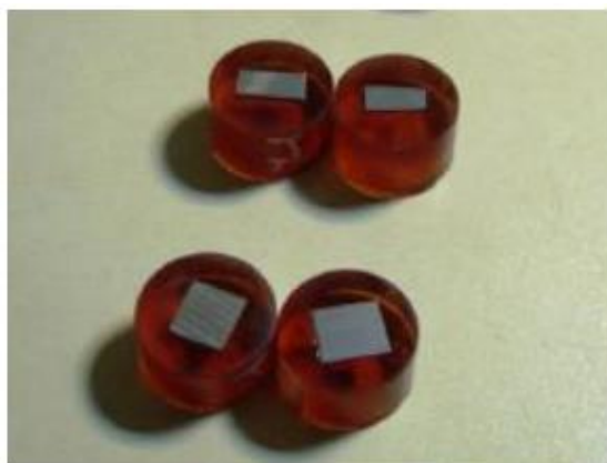
شکل ۸) نمونه های مانت متالوگرافی
