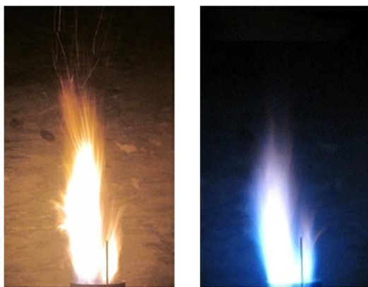
شکل 2 تصویر شعله (الف) بدون تزریق و با تزریق ذرات زغال سنگ (ب)
