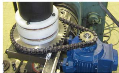
شکل ۱۰ سیستم انتقال قدرت ساخته شده بر اساس مدل سه‌بعدی
