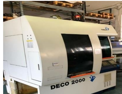
شکل ۲) ماشین ابزار مدل سویسی برند TORNOS DECO 2000 مورد استفاده جهت انجام آزمایش ها
