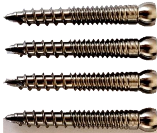
شکل ۷) پیچ‌های تولید شده توسط فرایند رزوه تراشی گردابی
