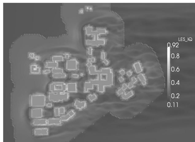
شکل 8 کیفیت نتایج LES در مدل اسماگورینسکی در صفحه z = 1.75 m
