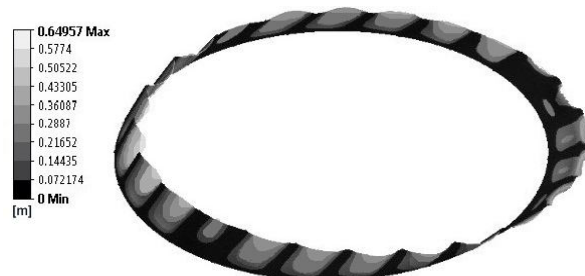
شکل 16 کانتور کرنش در حلقه الاستیک
