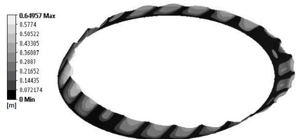
شکل 16 کانتور کرنش در حلقه لاستیک
