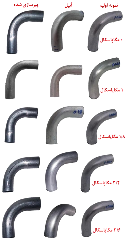
شکل ۸) لوله‌های خم شده اولیه، آنیل و پیرسازی شده در فشارهای سیال مختلف
