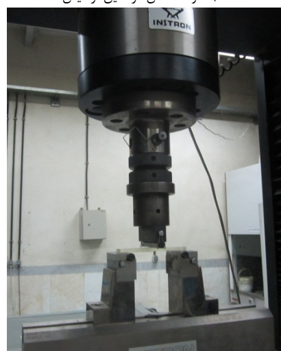
ب) نمونه خمش سه نقطه‌ای در حین آزمایش شکل ۲ نمونه‌های کشش و خمش در حین آزمایش
