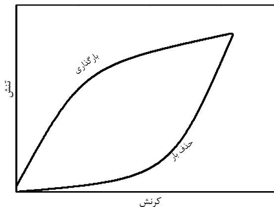
شکل ۳ منحنی تنش-کرنش پارچه (هیستریزس) [۱۴]
