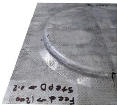
شکل ۱۴) آزمون ۱۳ برجستگی و اعوجاج سطح شکل‌دهی شده
