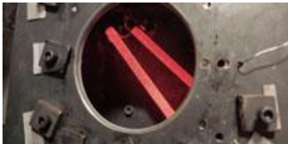
شکل ۱) سیستم گرمایش قالبی ورق‌ها
