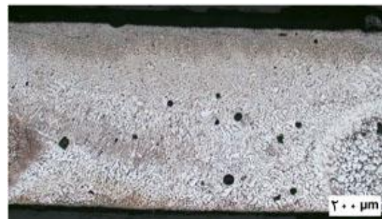
شکل ۵) ریزساختار مقطع جوش ورق آلومینیم ۶۰۶۱ و ۵۰۸۳
