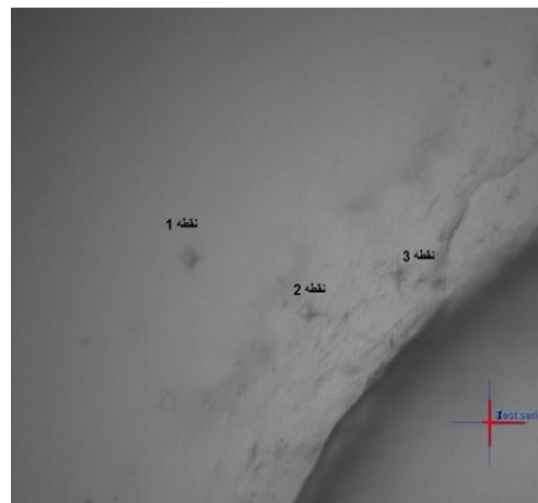
شکل ۷) الف) نقاط اندازه‌گیری سختی
