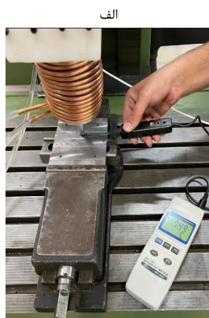
شکل ۶) چگالی شار مغناطیسی، (الف) نتایج اندازه‌گیری و شبیه‌سازی (ب) نحوه اندازه‌گیری با گوس‌متر
