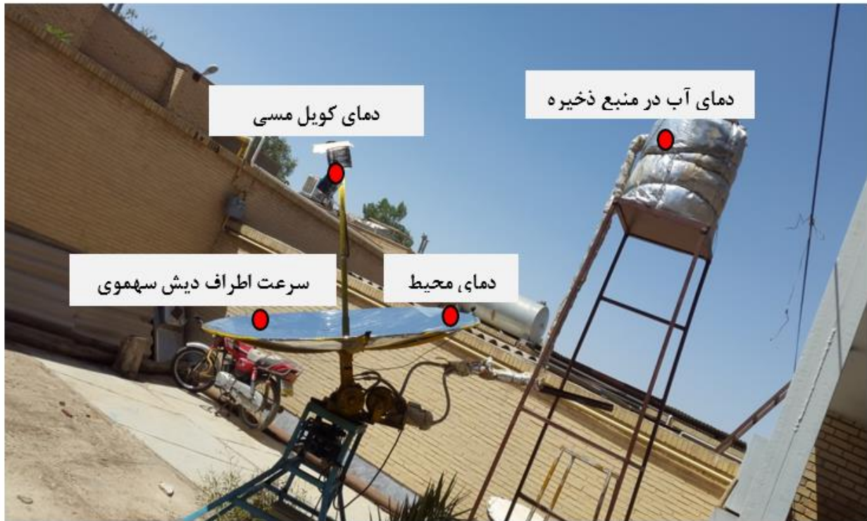
شکل ۳) نقاط اندازه‌گیری دما و سرعت در سیستم دیش سهموی خورشیدی
