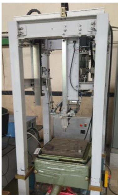
شکل ۳) نمایی از دستگاه واقعی ماشین فرز ۴ درجه آزادی با سازوکار موازی
