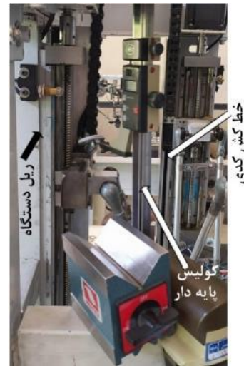
شکل ۶) اندازه‌گیری خطاهای موقعیت‌دهی محورهای حرکتی
