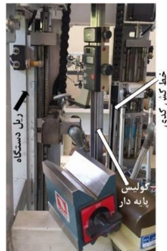
شکل ۶) اندازه‌گیری خطاهای موقعیت‌دهی محورهای حرکتی
