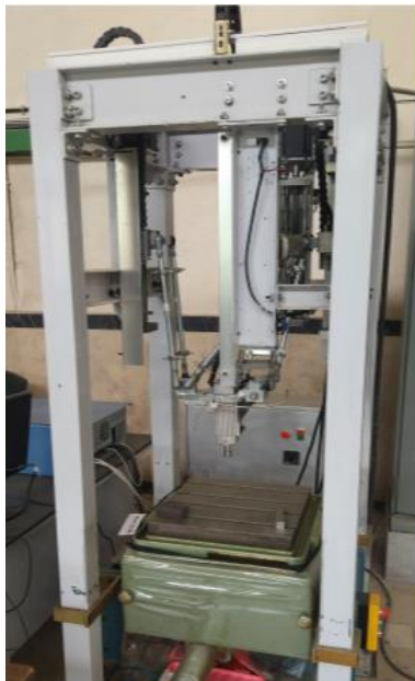
شکل ۳) نمای از دستگاه واقعی ماشین فرز ۴ درجه آزادی با سازوکار موازی
