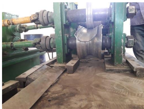
شکل ۵) انجام عملیات شکل دهی بر روی ورق
