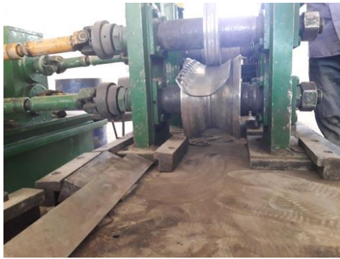
شکل ۵) انجام عملیات شکل دهی بر روی ورق
