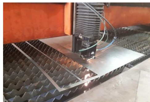
شکل ۴) سوراخ زدن و برش ورق با دستگاه لیزر
