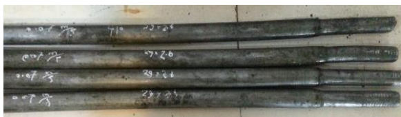
شکل ۸) لوله‌های کشش شده
