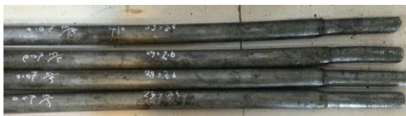
شکل ۸) لوله‌های کشش شده
