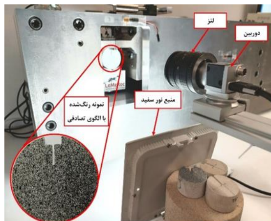
شکل ۳) تجهیزات مورد استفاده در روش برهم‌نگاری تصاویر دیجیتال.
