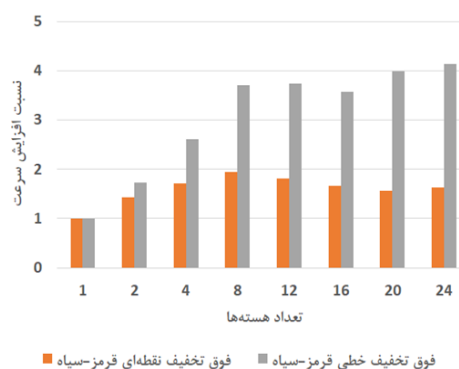
شکل ۵) نسبت افزایش سرعت برای روش‌های گرادیان مزدوج برای شبکه ۵۱۳ \times ۵۱۳
