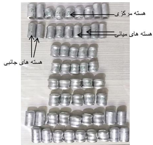
شکل ۸) تغییر شکل هسته‌های سازه پس از بارگذاری
