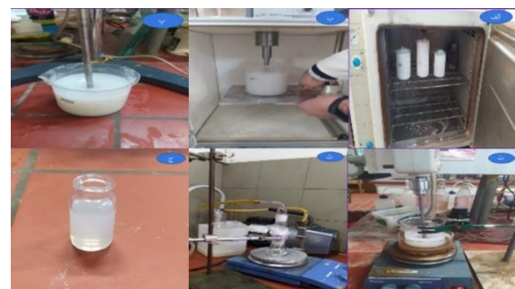
شکل ۲) نمایی آماده سازی سیال غلیظ شونده برشی: (الف) رطوبت زدایی از سیلیکای دوده شده، (ب) آلتراسونیک مواد، (پ) اختلاط مستقیم مواد با یکدیگر، (ت) همزدن و الکل زدایی، (ث) حباب زدایی، (ج) سیال غلیظ شونده برشی
