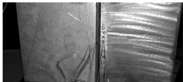
شکل 3 اتصال ترموکوپل‌ها به قطعه به صورت تجربی
