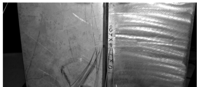
شکل 3 اتصال ترموکوپل‌ها به قطعه به صورت تجربی
